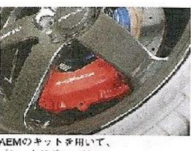
AEMのキットを用いて、ブレーキはグレードアップされている。ノントップに装備されているのはブルシェル正。パッドもブルシェルを止めたが、リーキットでも十分な効き。
